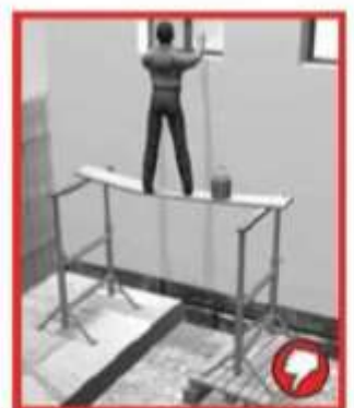
Zajistit dostatečně stabilní pracoviště, vč. zábradlí – HROZÍ PÁD!
