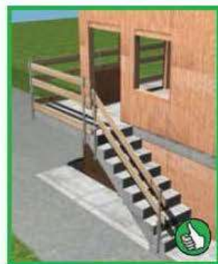
Provést zábradlí u volných prostor, kde hrozí pád
