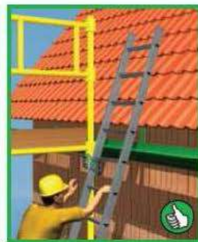
Přesah min. 1,1 m nad výstup/práci
