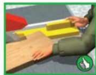
Posun pomůckou při dořezu nebo řezání krátkého materiálu
