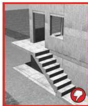
Provést zábradlí u volných prostor, kde hrozí pád
